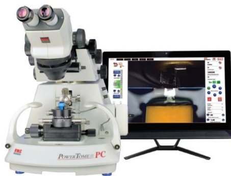
Abbildung 7: Ultramikrotom mit integriertem Stereomikroskop und inkludiertem PC
