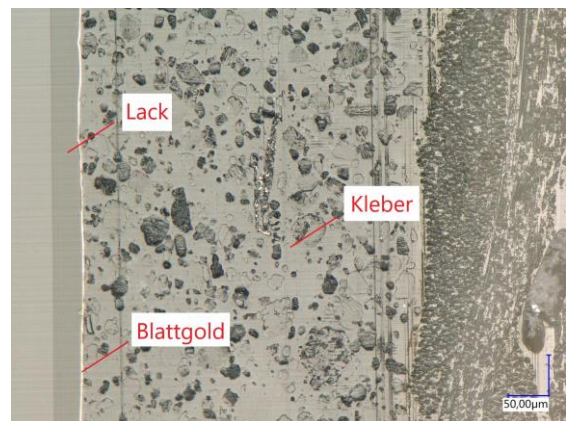
Abbildung 8: Querschnitt einer lackierten Wabenplatte mit Blattgold. Oben wurde die Probe geschliffen und poliert, dadurch kam es zu Artefakten bzgl. der Schichtdicken, des Weiteren blieben Reste vom Schleifen/Polieren im Kleber haften.
